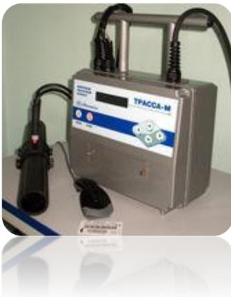
[Стыковой сварочный аппарат](#)
